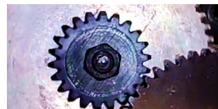
Испытание инженерного фотополимера в редукторе обрабатывающего станка
